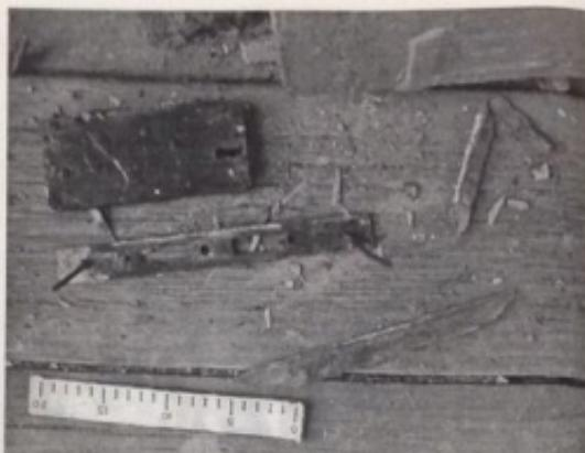
Фото 4. Короб врезного замка, обнаруженный под входной дверью.
